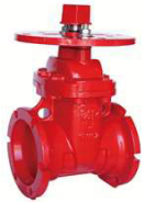
VÁLVULA COMPUERTA VÁSTAGO FIJO C/PLATO MJ X MJ DIÁMETROS DE 4" A 12"
